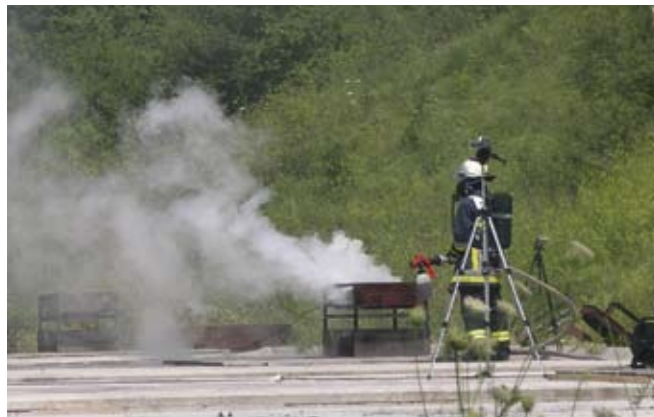
Löschversuche 2012: links: Abblasende Lithium-Ionen-Batterie in Vollbrand rechts: gelöschte Lithium-Ionen-Batterie
