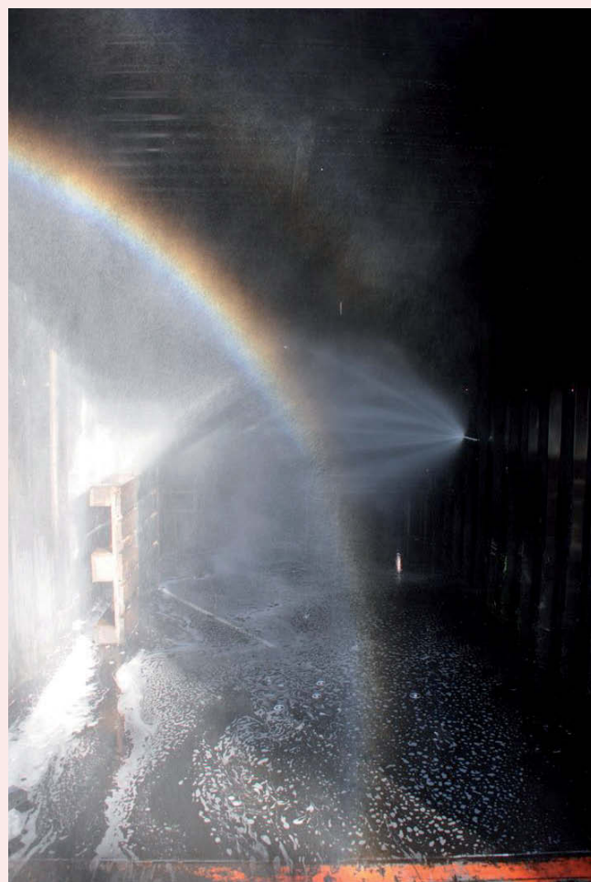
Feiner Wassernebel füllt den Container.
