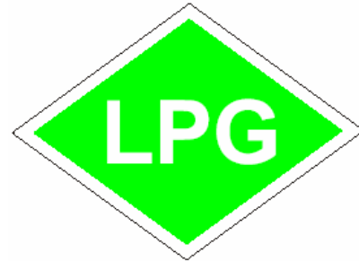
Bild 2 Kennzeichnung von mit Flüssiggas betriebenen Kraftfahrzeugen der Klassen M2 und M3 (Nutzfahrzeuge)
